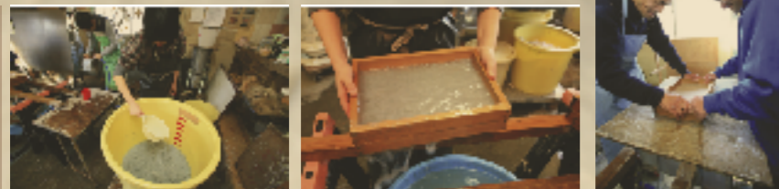
1. 目盛りに合わせて水を足しながら材料を攪拌。 2. 枠に流し込み、漉きます。 3. 上の枠を外します。
